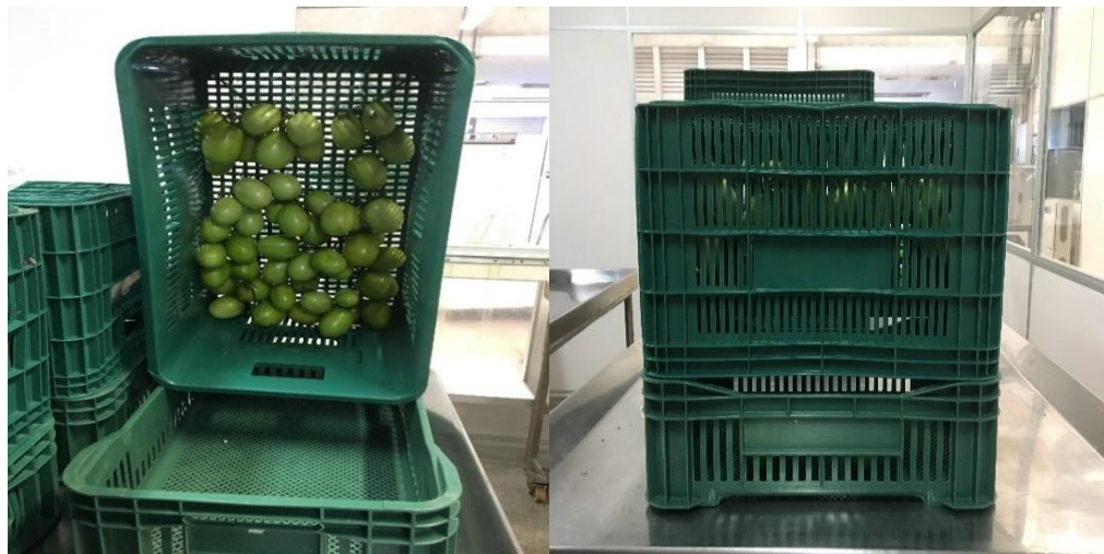
Figura 6. Estrutura em “gaiola” montada para verificação do despencamento natural de frutos de tomate no cacho durante 12 dias de armazenamento.
