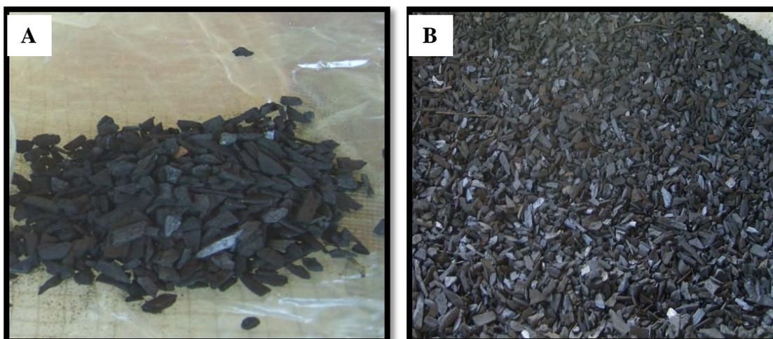
**Figura 5:** “fino de carvão vegetal” após peneiramento em malhas de 5mm (A) e 3mm (B) ( Partículas  $\leq$  a 5mm e partículas  $\leq$  a 3mm).
