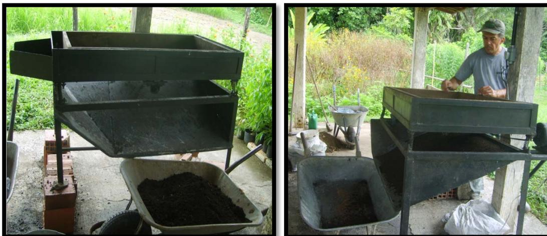
**Figura 3.** Peneira elétrica utilizada no processamento do vermicomposto estabilizado.
