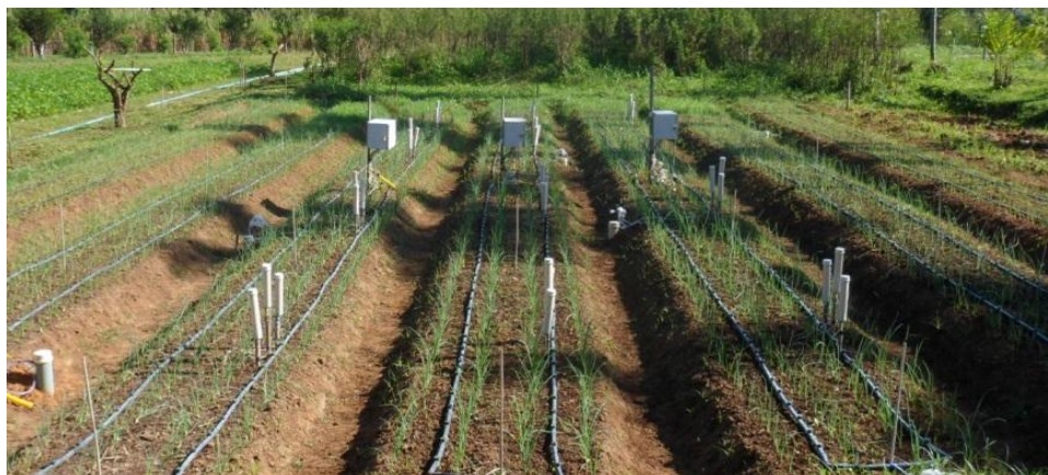
Figura 5. Disposição dos tensiômetros e “dataloggers” nos blocos 2, 3 e 4.
