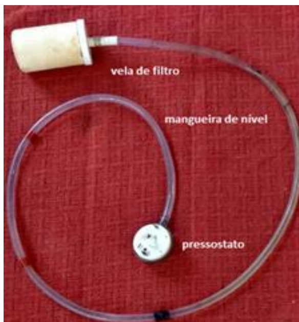
Figura 2. Peças usadas para confecção do sistema de acionamento
