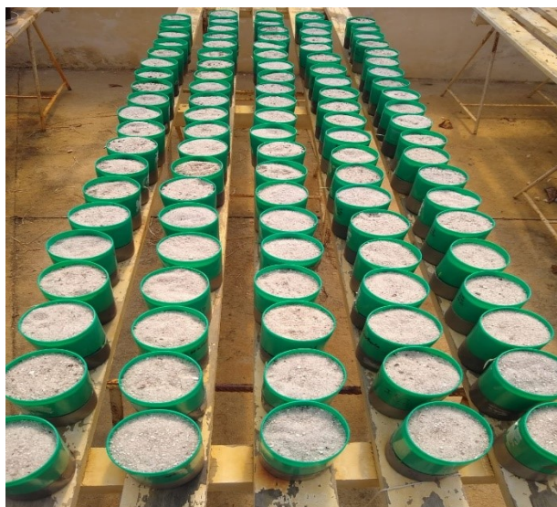
Figura 1 - Vasos com coletores de lixiviado preenchidos com areia e com compostos fermentados.
