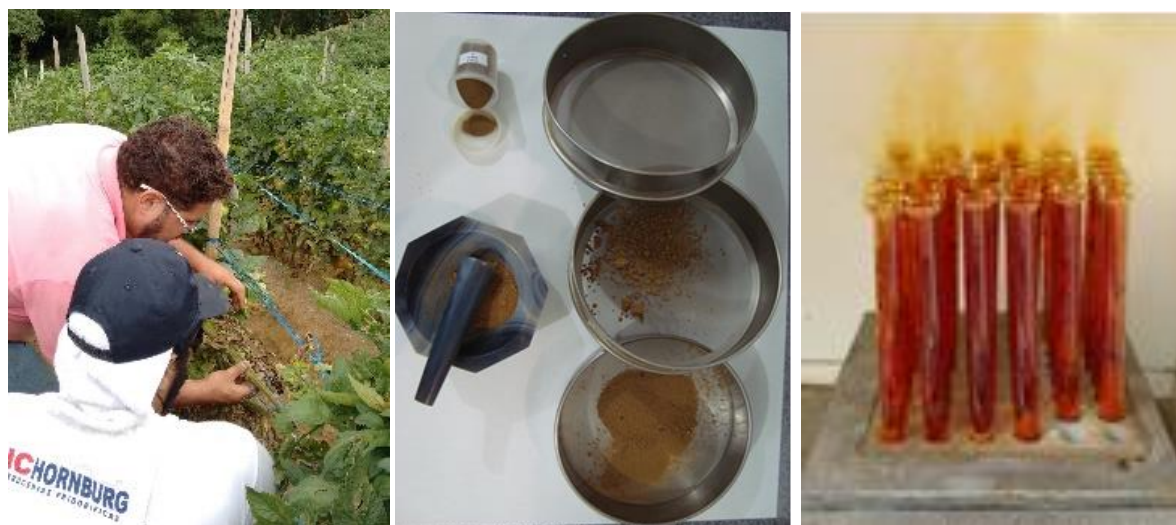
Figura 3: Coleta das amostras de solo (A); preparo das amostras (B); digestão das amostras de solo (C).
