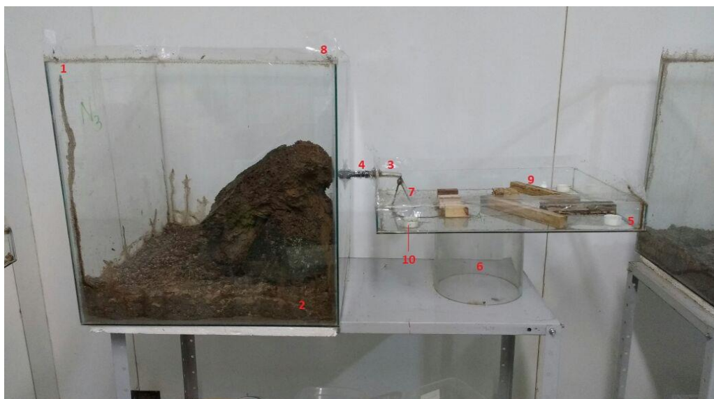
Figura 4. 1– Cuba de vidro; 2– Camada de areia; 3– Tubo de silicone; 4– Tubo de pvc; 5– Arena de forrageamento; 6– Tubo de acrílico; 7– Rampa de acesso; 8– Fita adesiva; 9- Fonte de alimento; 10- Tampa de garrafa PET.
