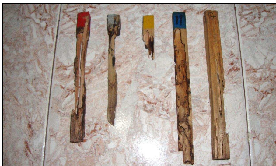
Figura 24. Exemplo de danos causados pelos térmitas às estacas de madeira de diferentes espécies florestais ( Eucalyptus urograndis , Corymbia citriodora , Eucalyptus cloeziana , Eucalyptus saligna e Pinus elliottii , da esquerda para direita).
