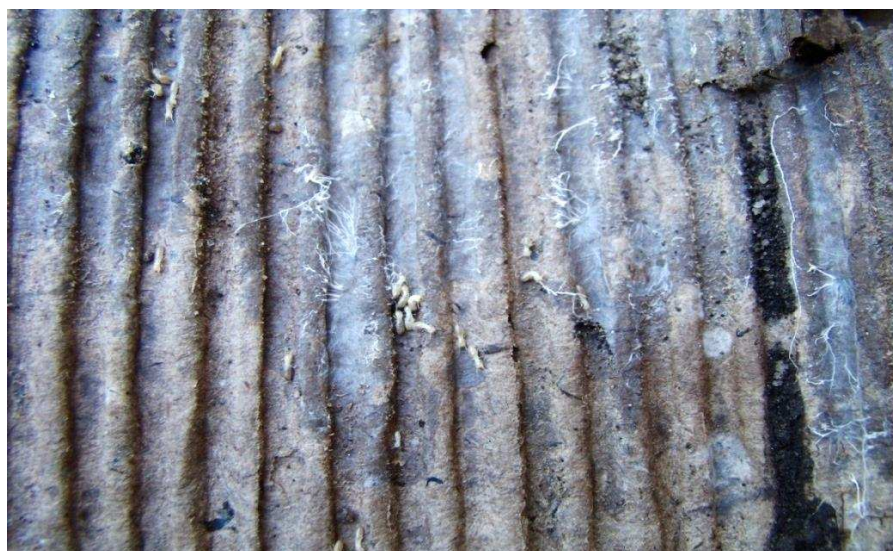
Figura 10. Isca Termitrap® aberta atacada por térmitas subterrâneos com presença de operárias.
