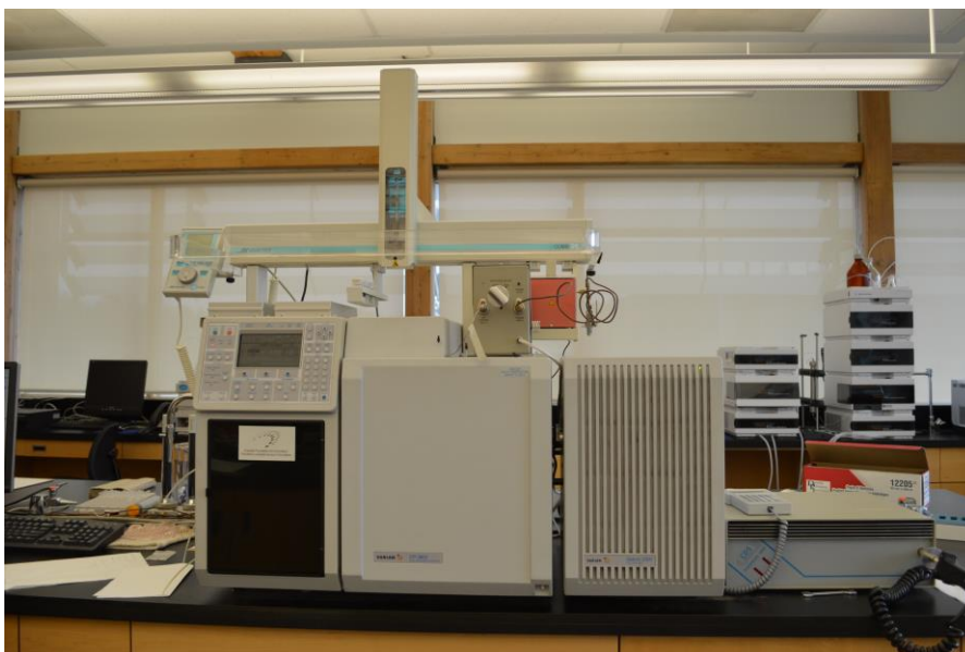
Figura 13. Conjunto PI-CG/EM. Da direita para esquerda: Pirolisador, espectrômetro de massa e cromatógrafo gasoso.
