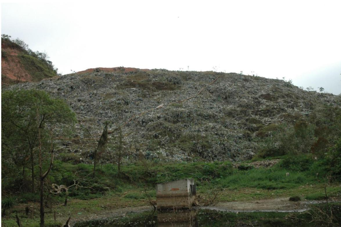
**Fig. 05:** Vista parcial do lixão municipal antes das medidas solicitadas pelo Ministério Público na Ação Civil Pública. Atentar para a disposição inadequada dos resíduos e para a lagoa de acúmulo de chorume à jusante da pilha de lixo.
