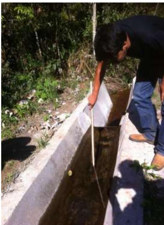
**Figura 12.** Medição da vazão pelo método de vertedor trapezoidal.
