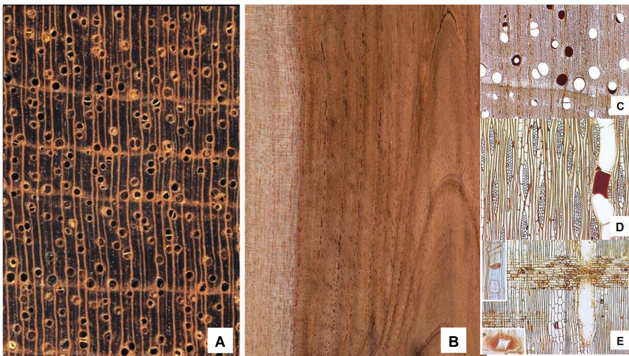
Figura 1. Madeira de Cedrela odorata . (A-B) Imagens macroscópicas das seções transversal e tangencial, respectivamente. (C-E) Imagens microscópicas das seções transversal, tangencial e radial, respectivamente (RICHTER; DALLWITZ, 2009).
