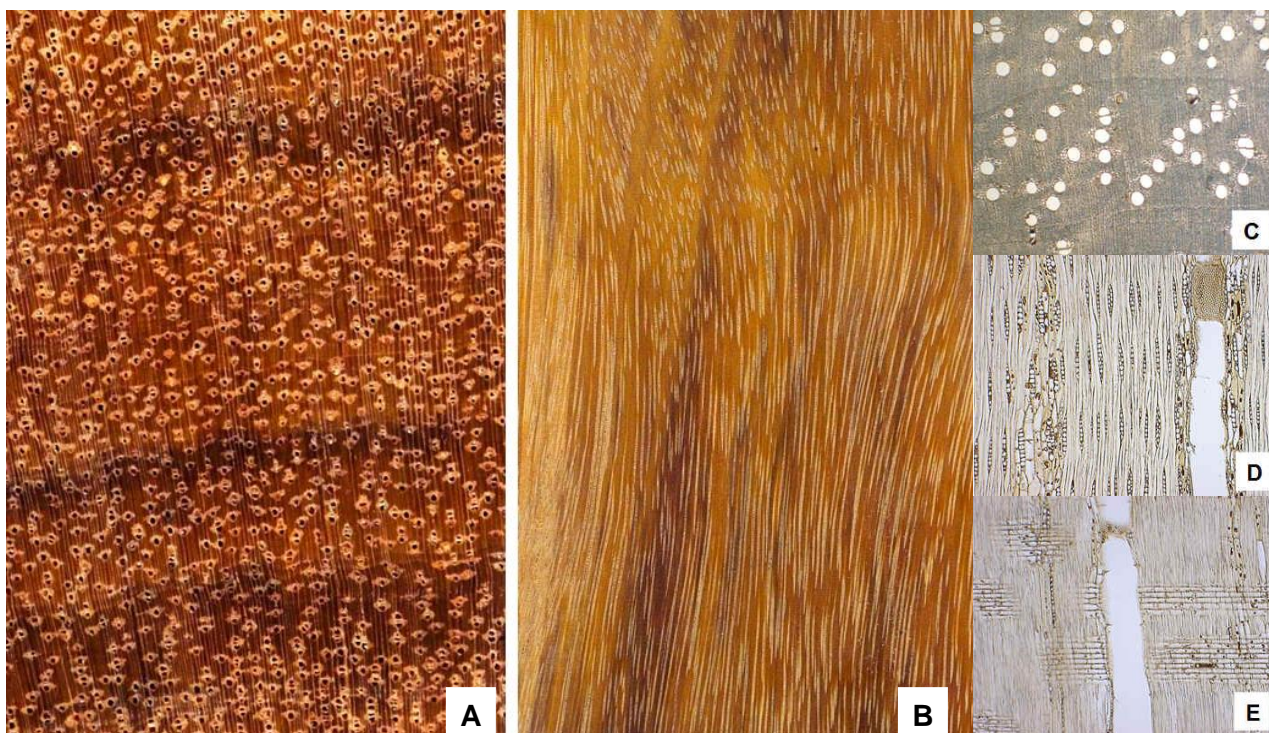
Figura 2. Madeira de Dipteryx odorata . (A-B) Imagens macroscópicas das seções transversal e tangencial, respectivamente. (C-E) Imagens microscópicas das seções transversal, tangencial e radial, respectivamente (RICHTER; DALLWITZ, 2009).
