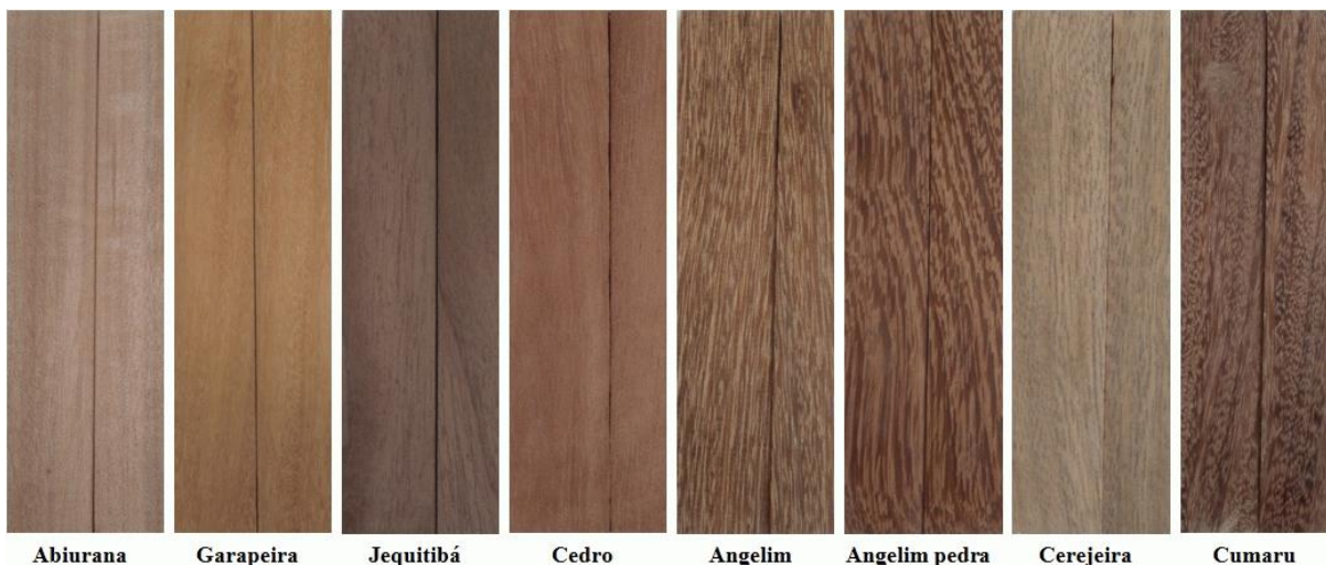
Figura 8. Aspecto visual da superfície das oito madeiras amazônicas estudadas.
