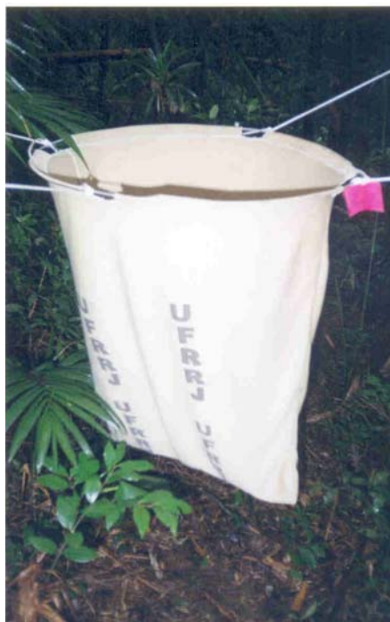
Figura 5: Coletor empregado na amostragem de serapilheira e chuva de sementes na área de estudos de um hectare, PARNASO, Teresópolis, RJ.
