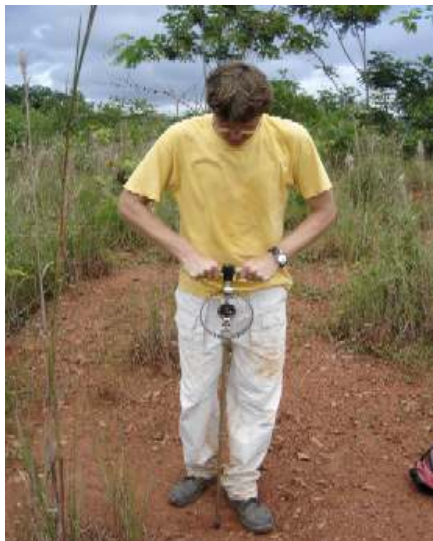
Figura 1: Teste de resistência dos substratos realizado nas medidas biológicas e testemunha da AE-2 na UHE Tucuruí.
