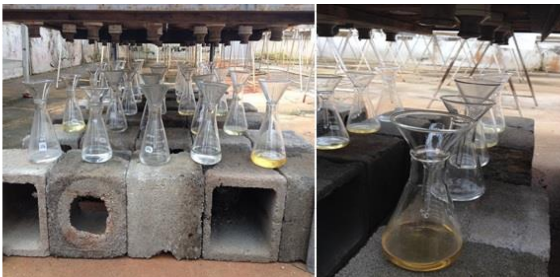
Figura 4. Coleta do material lixiviado em frascos Erlenmeyers com funil acoplado e disposto abaixo das colunas de lixiviação.
