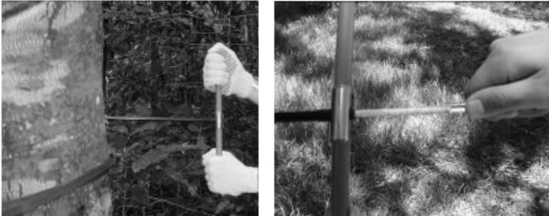
**Figura 7.** Amostragem realizada com trado de incremento para retirada de amostra de madeira.
