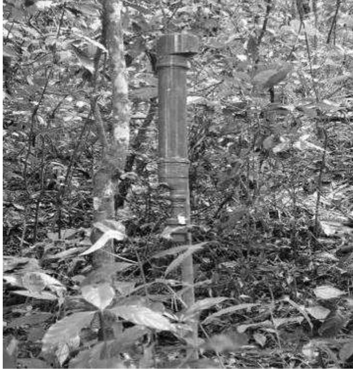
**Figura 10.** Pluviômetro instalado dentro das áreas de estudo para a quantificação da precipitação interna.
