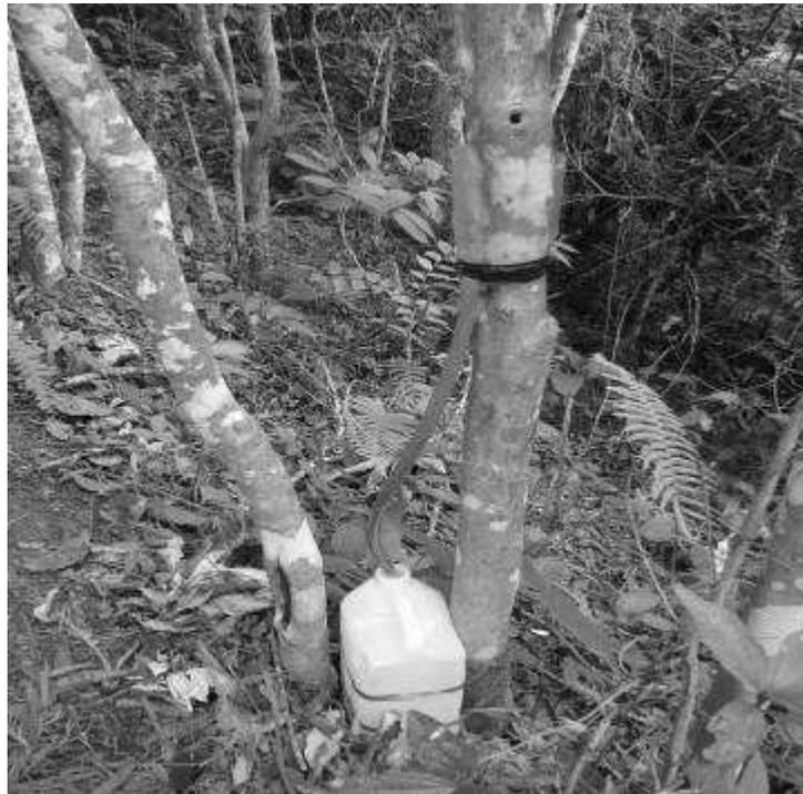
**Figura 12.** Coletor de escoamento de tronco instalado nas áreas de FSEI e FSEM em Pinheiral – RJ.
