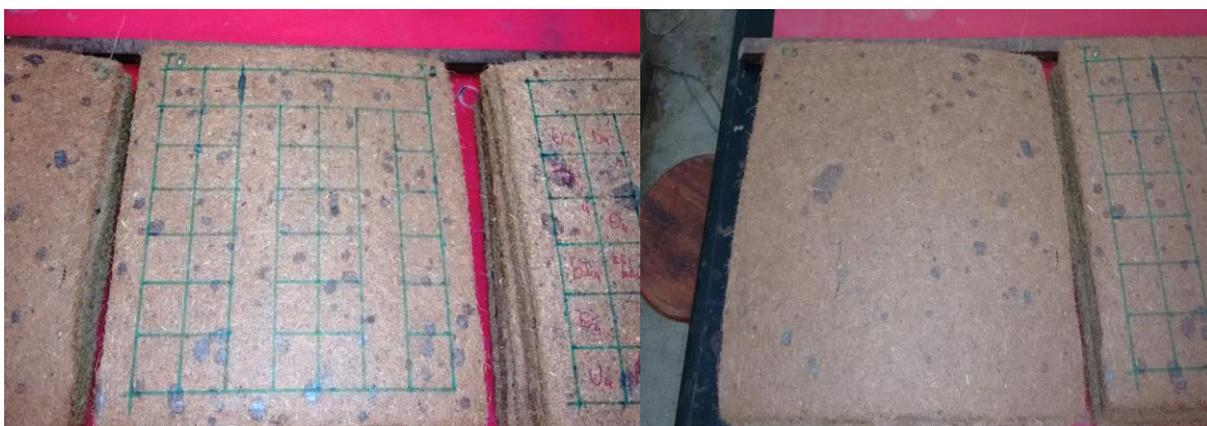
**Figura 14.** Painéis fabricados com mesocarpo do coco. Fonte: Autora.
