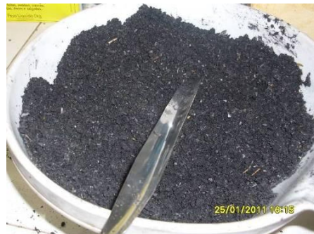
Figura 6. Preparo das misturas das matérias-primas pra confecção dos briquetes.
