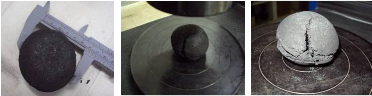
Figura 12. Medição e aplicação de carga nos ensaios de resistência à compressão.
