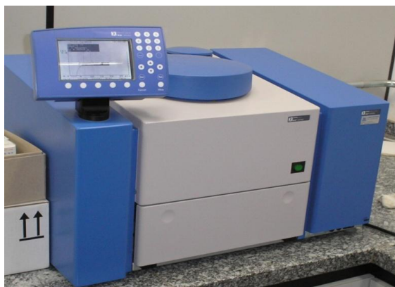
Figura 16. Calorímetro Ika Werke, modelo C500 Control utilizado na determinação do PCS.
