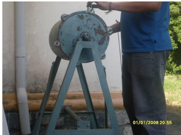
Figura 14. Tambor rotativo utilizado nos ensaios de tamboramento.
