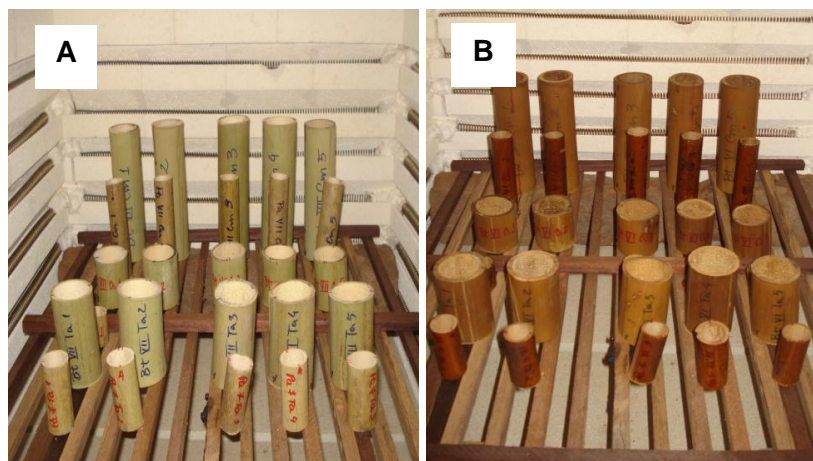
Figura 11. (A) Amostras no interior do forno antes do tratamento de termorretificação. (B) Amostras no interior do forno após o tratamento de termorretificação.
