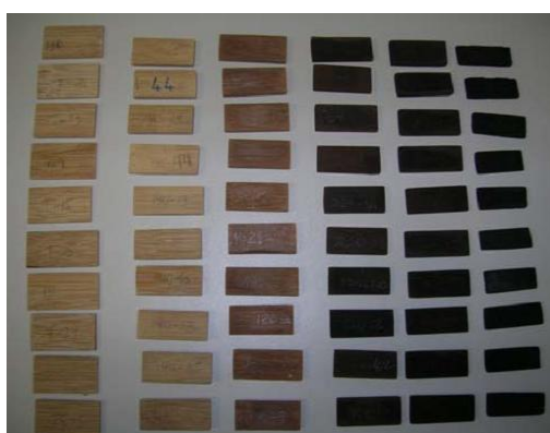
Figura 9. Diferença na cor das amostras termorretificadas de Dendrocallamus giganteus (Fonte: BERALDO et al., 2009).
