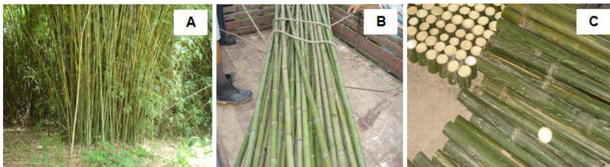
Figura 10. (A) Povoamento de Bambusa tuldoides . (B) Coleta dos colmos de Phyllostachys aurea . (C) Colmos de Bambusa tuldoides seccionados nas dimensões dos ensaios físico-mecânicos.
