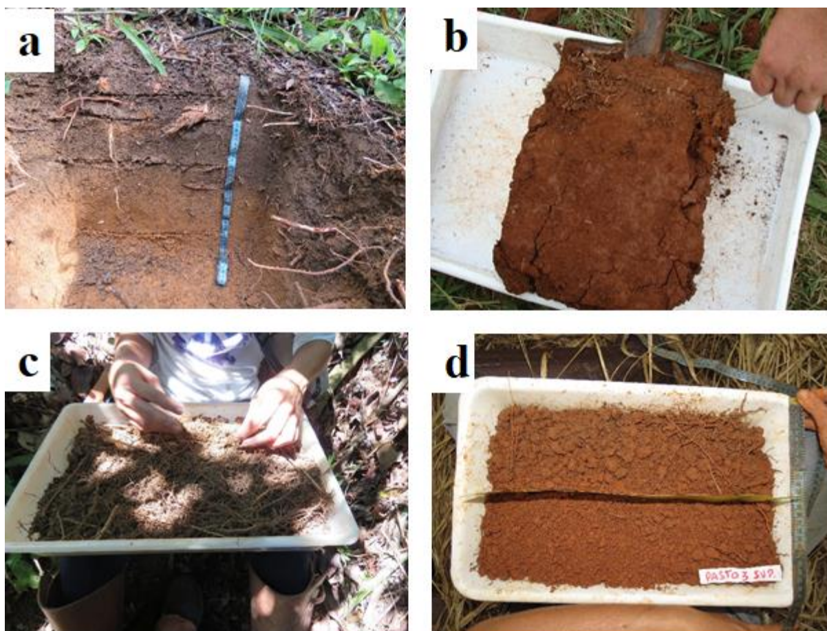
Figura 8. Etapas de obtenção do monólito e resultado da manipulação para avaliação da estrutura do solo pelo método do DRES (RALISCH et al., 2017). a) Mini-trincheira; b) Monólito; c) Manipulação da amostra; d) Separação de camadas.
