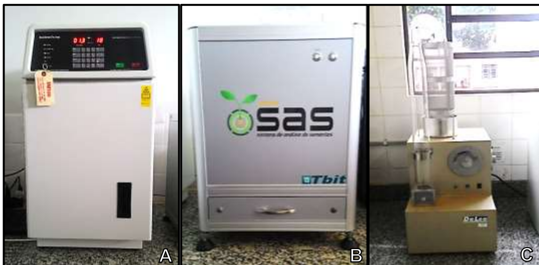
Figura 1.2. Equipamentos utilizados para classificação, avaliação e separação das sementes da espécie florestal M. polymorphum . A: raios X (Faxitron X-ray); B: mini-SAS; C: soprador de sementes tipo General (DeLeo).
