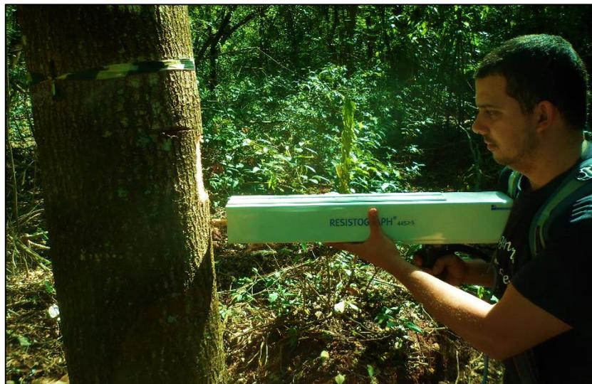
**Figura 9.** Medição da resistência da madeira a penetração broca utilizando o resistógrafo.
