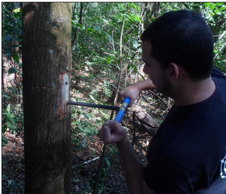
**Figura 11.** Extração das amostras do lenho utilizando-se a Sonda de Pressler.
