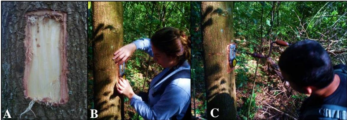
**Figura 8.** A: Abertura de painel para fixação do extensômetro. B: Fixação do extensômetro. C: Perfuração do tronco com arco de pua para liberação das tensões.
