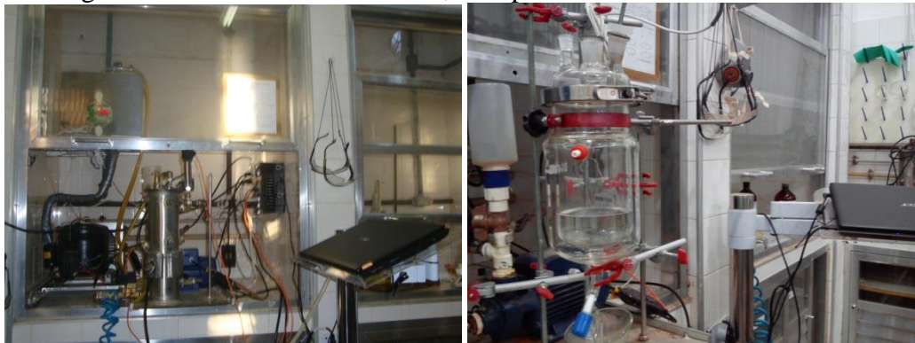
Figura 8. Reator de ozonólise, em aço inoxidável (a), e em vidro borossilicato (b).
