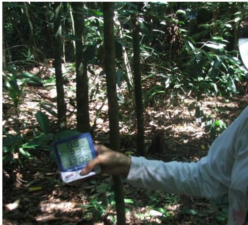
**Figura 2.2.** Leitura da temperatura e umidade relativa do ar com o termohigrômetro, Município de Vassouras, Rio de Janeiro, Brasil.
