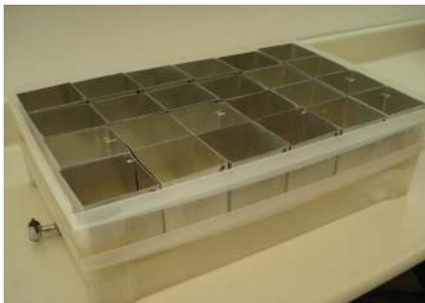
**Figura 24:** Subamostrador (64 x 36 cm) utilizado para homogeneizar a amostra e no auxílio da separação dos *quadrats* após o procedimento da lavagem e retirada do material grosseiro (Foto: LAPSA/ FIOCRUZ).
