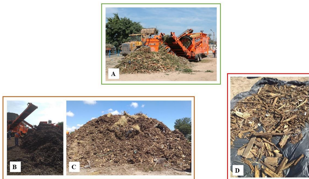
Figura 3. Resíduos madeireiros de origem urbana. (A) = Picador modelo EDGE TRM516 na ETR-Caju; (B) = Local de coleta e amostragem do material. (C) = Pilha de RMOU. – D: Separação do material.
