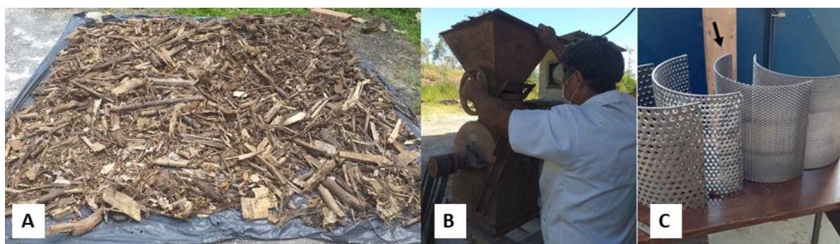
Figura 4. Pré-processamento do material. (A) = Secagem ao ar livre; (B) = Trituração do material em moinho de martelo; (C) = Peneiras de corte do moinho de martelo (4,5 mm).
