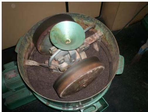
**Figura 1.** Misturador de laboratório com as duas mós e o funil para abastecimento de água
