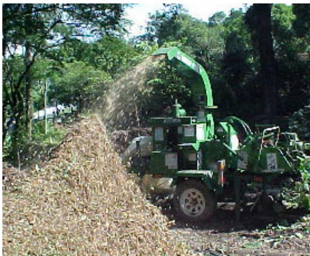
**Figura 2** – Equipamento triturando galhadas
