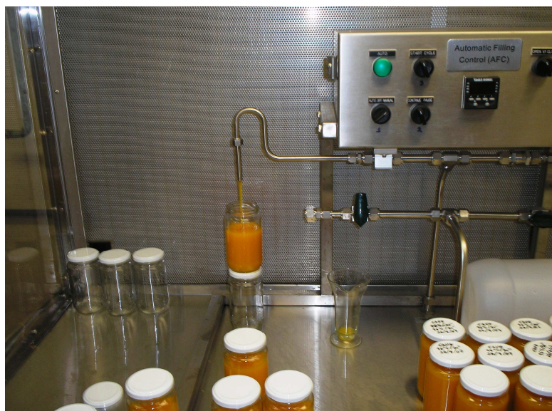
Figura 15. Envase do suco de tangerina pasteurizado em embalagens de vidro em unidade ultralimpa
