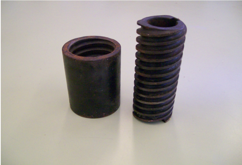
Figura 2. Rosca ou parafuso e sua respectiva camisa da extrusora Inbra RX50 (créditos: Erika Madeira M. da Silva)
