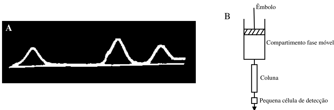
Figura 16 – (A) Fotografia de um dos experimentos de cromatografia de adsorção de Tiselius e (B) Diagrama de dispositivo para cromatografia.
