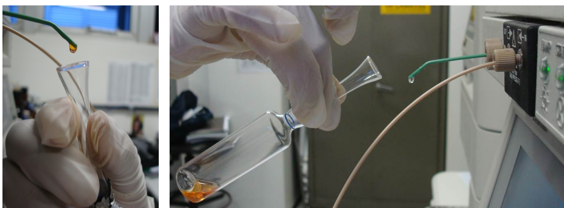
Figura 51 – Coleta manual de um carotenoide na saída do detector do CLAE analítico.
