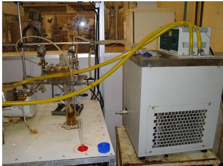
**Figura 7.** Sistema de ultrafiltração onde foram realizadas as operações de concentração por membrana.
