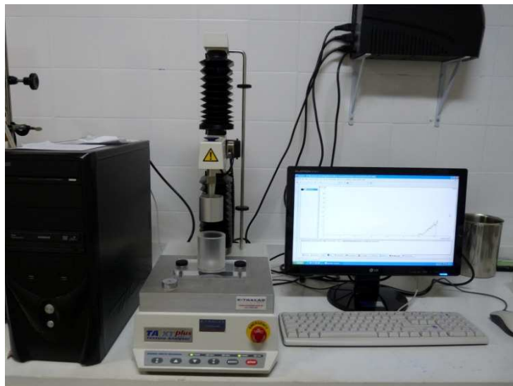
Figura 18: Texturômetro Analyser modelo XT.RA acoplado a microcomputador para análise de dados.
