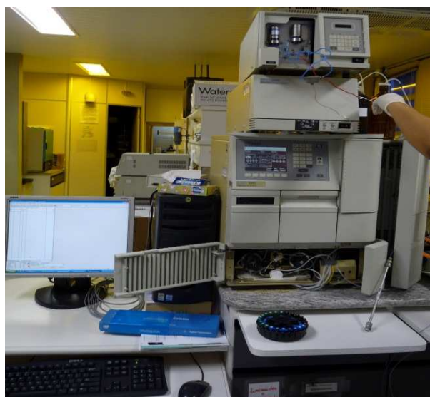
Figura 13: Sistema cromatográfico utilizado para avaliação de perda de frutanos durante processo por análise de açúcares.
