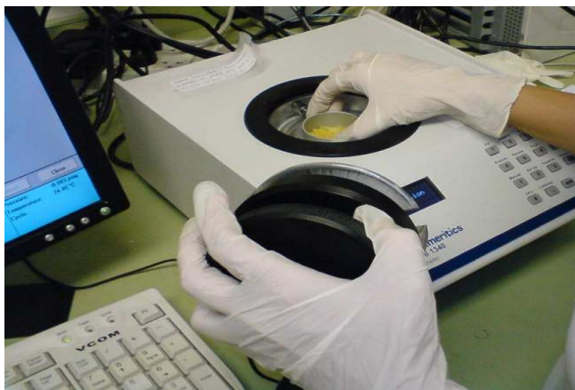
Figura 16: Picnômetro Micromeritics modelo AccuPyc II1340 para análise de densidade absoluta
