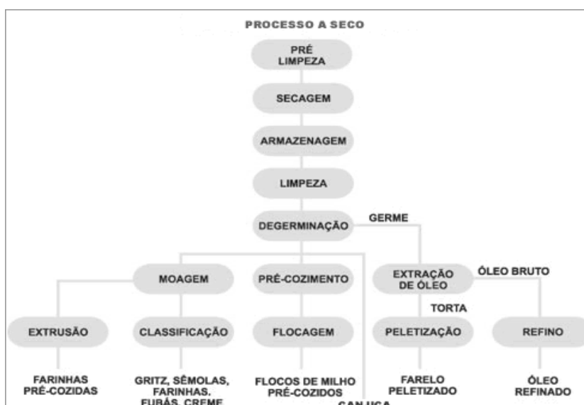
Figura 3: Processo de moagem de milho a seco. Fonte: ABIMILHO, 2008.
