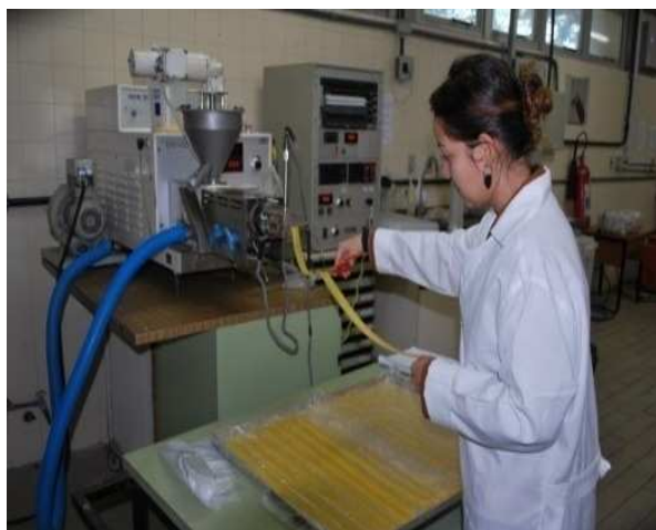
Figura 11: Processo de extrusão
