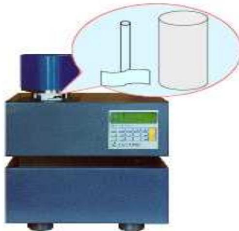
Figura 15: Desenho esquemático do RVA (Analisador Rápido de Viscosidade).
