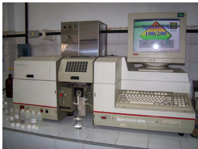
Figura 16: Espectrofotômetro de absorção de chama utilizado na quantificação de ferro e zinco.
