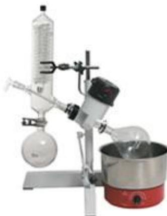
**Figura 4.** Evaporador rotativo.
