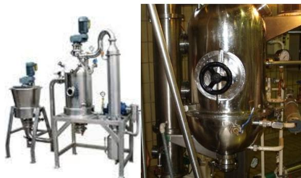
**Figura 9.** Conjunto concentrador a vácuo tipo “buller”.
