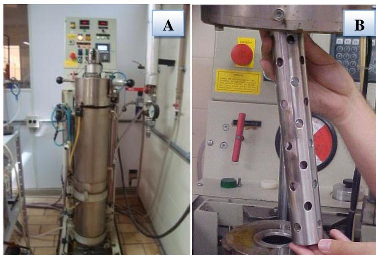
**Figura 6.** A) equipamento de APH Stansted Fluid Power e modelo S-FL-850-9-W, Inglaterra, B) cilindro com as amostras a serem pressurizadas\*. \*Fonte: SLONGO (2008).
