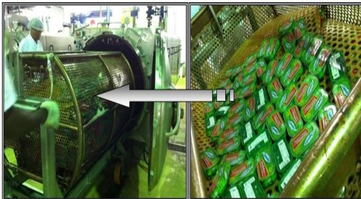
Figura 21: Vista frontal do acondicionamento das latas no autoclave industrial.
