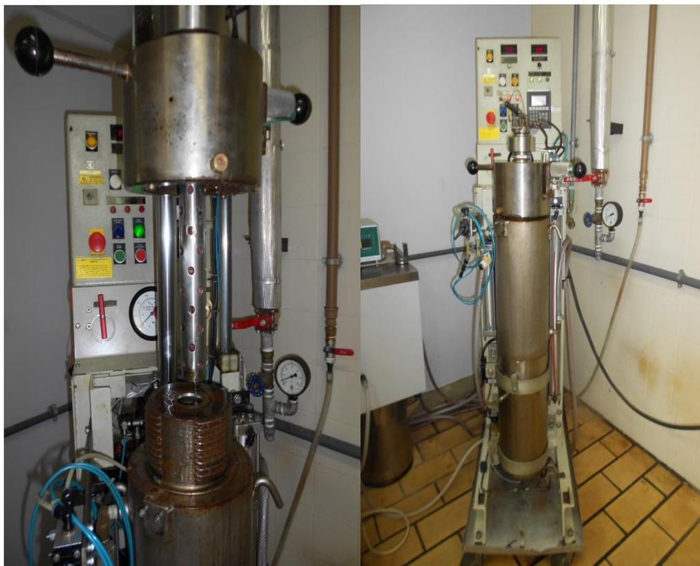
**Figura 5:** Aparelho de Alta Pressão Hidrostática - Marca *Stansted Fluid Power* e modelo *S-FL-850-9-w*.
