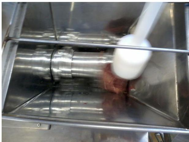
**Figura 10:** Funcionamento da despolpadeira.
