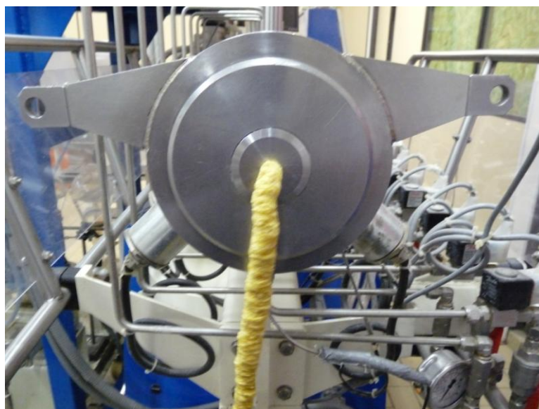
Figura 11 Extrudado de farinha de milho e pupunha saindo da matriz da extrusora Fonte: BASTO (2012)
