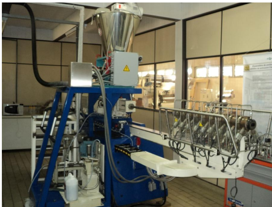
Figura 9 Extrusora dupla rosca, marca Clextral Evolum 25 HT (Firminy, França) Fonte: BASTO (2012)
