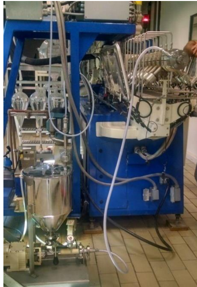
Figura 7. Extrusora de duplo parafuso com matriz de coextrusão e bomba de alimentação do recheio.
