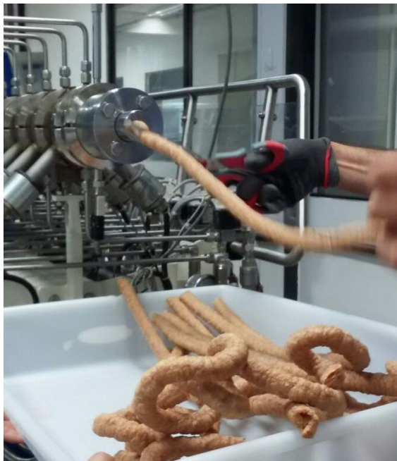
Figura12. Biscoitos extrudados saindo da matriz coextrusora cortados manualmente.
