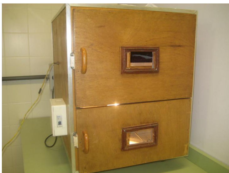
Figura 13. Secador convectivo com circulação de ar composto por bandejas em aço inox.
