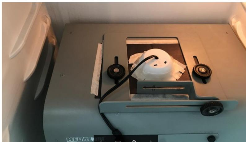
**Figura 9:** Câmara de fotografia MEDALIGHT Digital Imaging box acoplada com Câmera Dome Infravermelho
