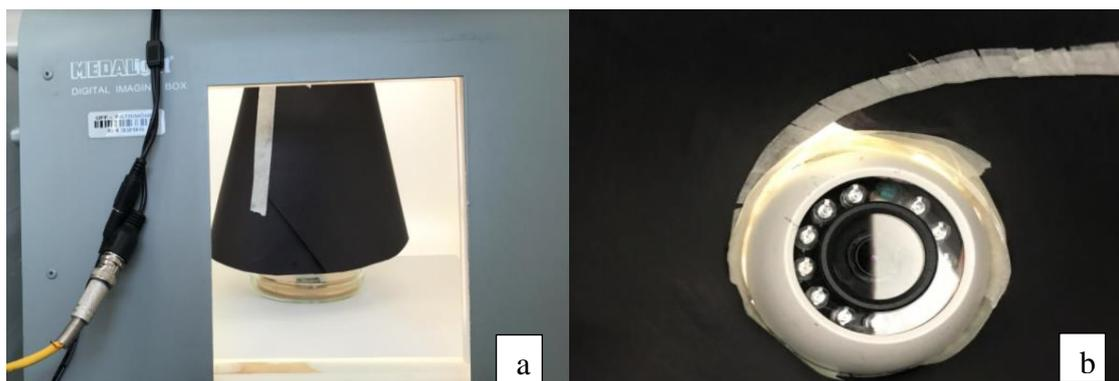
**Figura 11:** a: Cone de cartolina preta montado ao redor da placa de Petri; b: câmera de segurança envolvido pelo cone.
