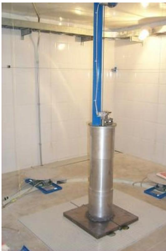
**Figura 10**- Interior da câmara de irradiação: mesas giratórias para posicionamento dos produtos a serem irradiados e protetor da fonte de cobalto 60.
