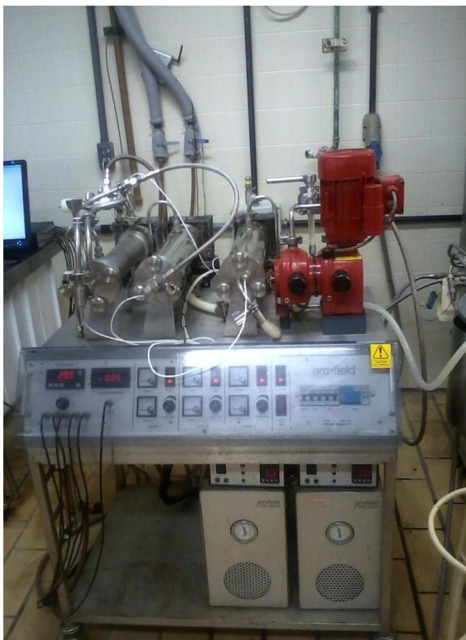
**Figura 8** - Pasteurizador em um trocador de calor de superfície raspada Armfield
