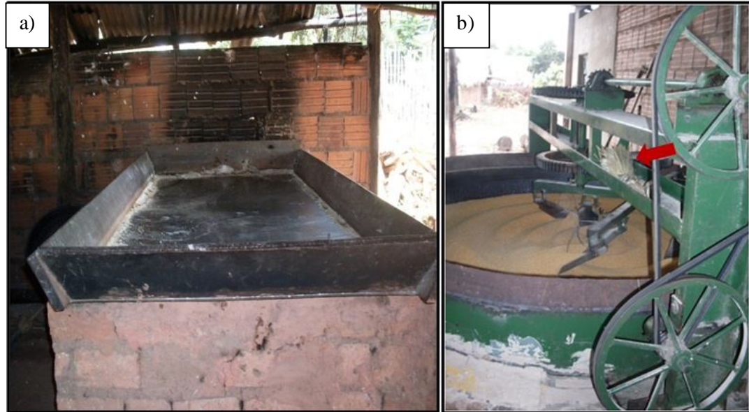
Figura 15. Tipos de fornos encontrados nas casas de farinha da Microrregião de Imperatriz, MA: a) forno retangular sem pás mexedoras; b) forno circular plano com pás mexedoras, em destaque vassoura utilizada na limpeza do forno.
