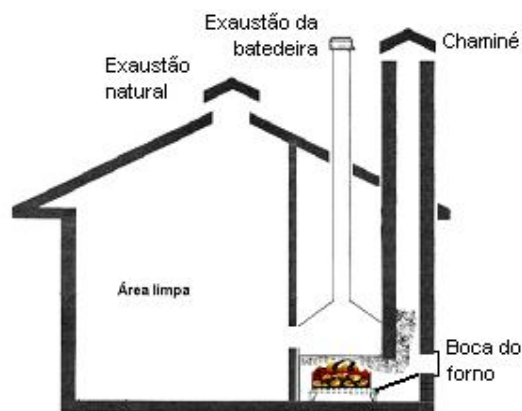
Figura 2. Desenho esquemático do forno e da chaminé.
