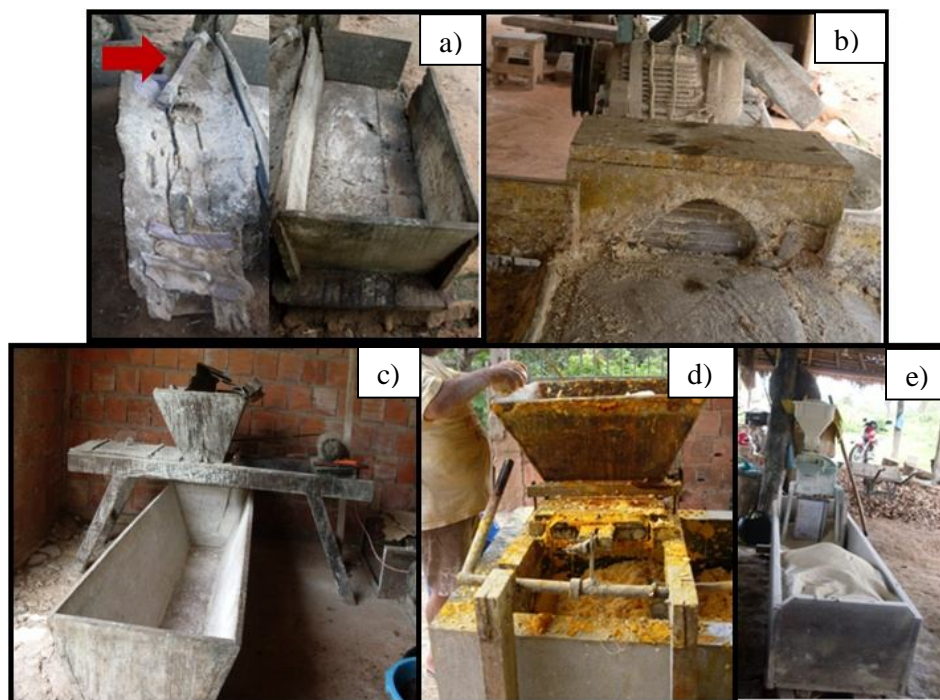
Figura 21. Trituradores da raiz de mandioca: a) triturador manual de madeira, em destaque “mão de pilão”; b) bola de caititu; c) bola de caititu com proteção de madeira; d) bola de caititu com proteção metálica; e) máquina forrageira.
