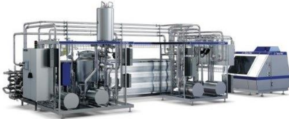
Figura 5. Equipamento para tratamento de UHT.
