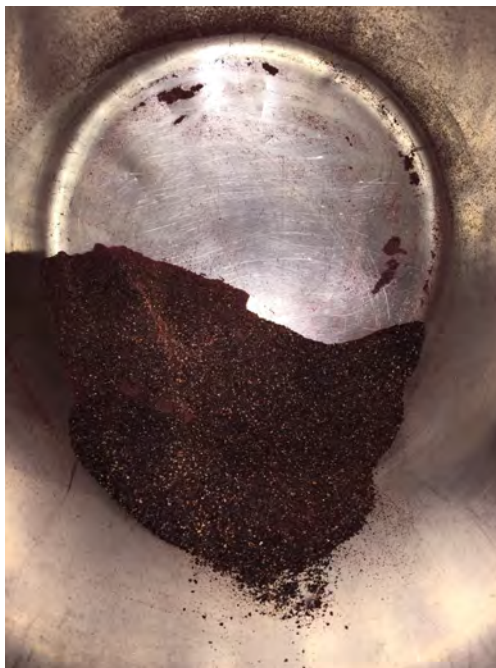
Figura 3 - Cascas de jaboticabas trituradas em moinho de martelo.
