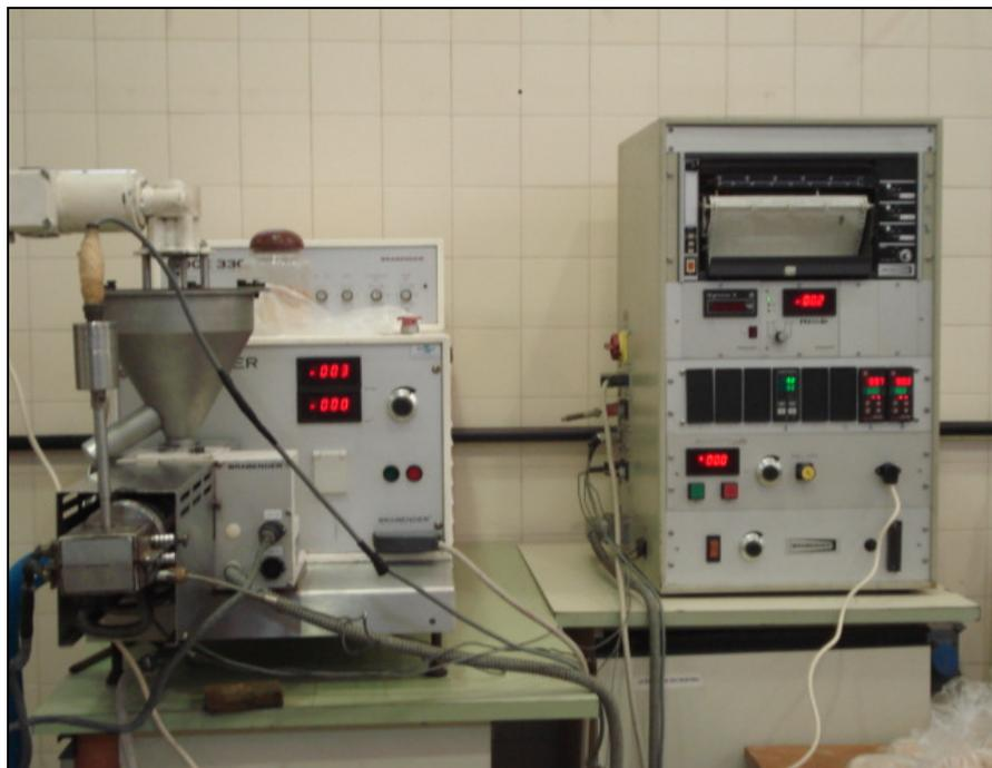
**Figura 4.** Extrusor monorosca, marca Brabender, modelo DSE 20 DN (Duisburg, Alemanha).
