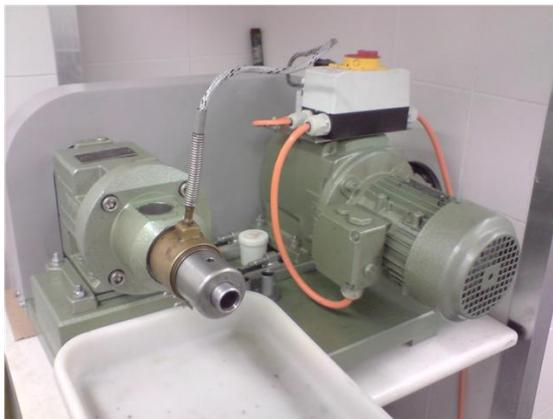
**Figura 7:** prensa elétrica tipo expeller.
