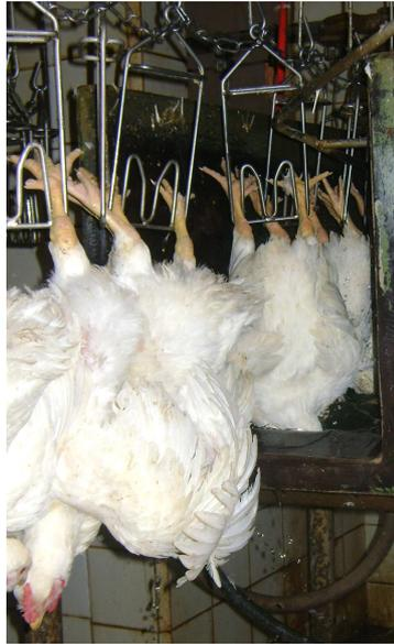
Figura 3. Aves sendo insensibilizadas por imersão da cabeça em água e corrente elétrica.
